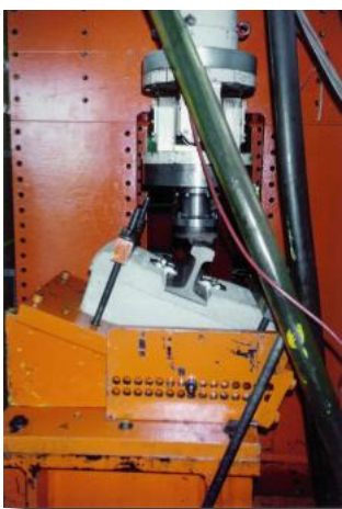
Teste dinâmico de fadiga das fixações S.75, considerando-se uma carga estática por eixo de 365 kN (3 milhões de ciclos).
