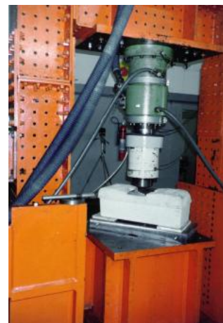
Teste dinâmico de fissuração da seção transversal sob o trilho (norma francesa).
