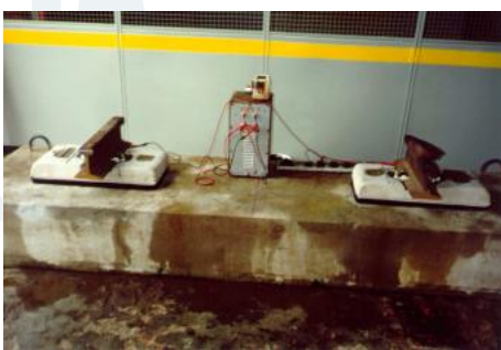
Teste de Resistividade, após imersão em água por 6 horas (norma norte-americana).
